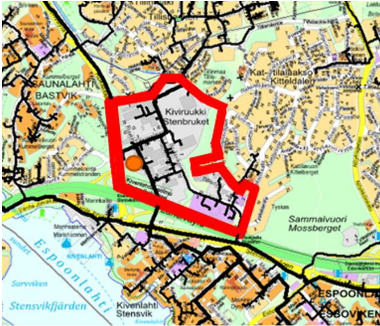
Kuva 3. Kaukolämpöverkoston. Runkolinja merkitty leveämmällä mustalla viivalla. Lämpölaitoksen sijainti merkitty oranssilla ympyrällä.
