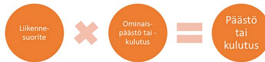
Kuva 13.2 Kunkin kulkumuodon päästöt muodostuvat liikennesuoritteiden ja kulkuneuvon yksikköpäästöjen tulona ja kokonaispäästö niiden summana.
