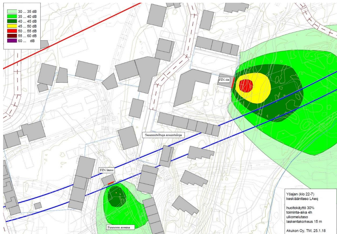
Kuva 32: Savunpoistopuhaltimien yöaikaisen huollon keskiäänitaso.
