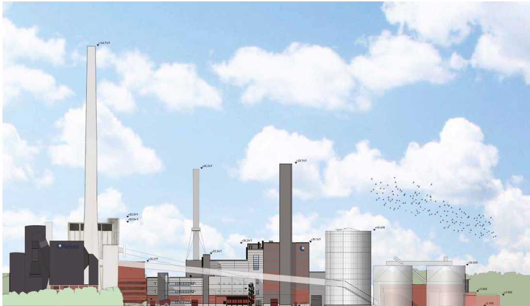
Kuva 22: Julkisivuprojektio etelästä voimalaitostontin suuntaan. Itäreunassa vaaleammalla on suunniteltu uusi rakentaminen, jotka ovat rakennuksia matalampia kuin nykyinen voimalaitos.
