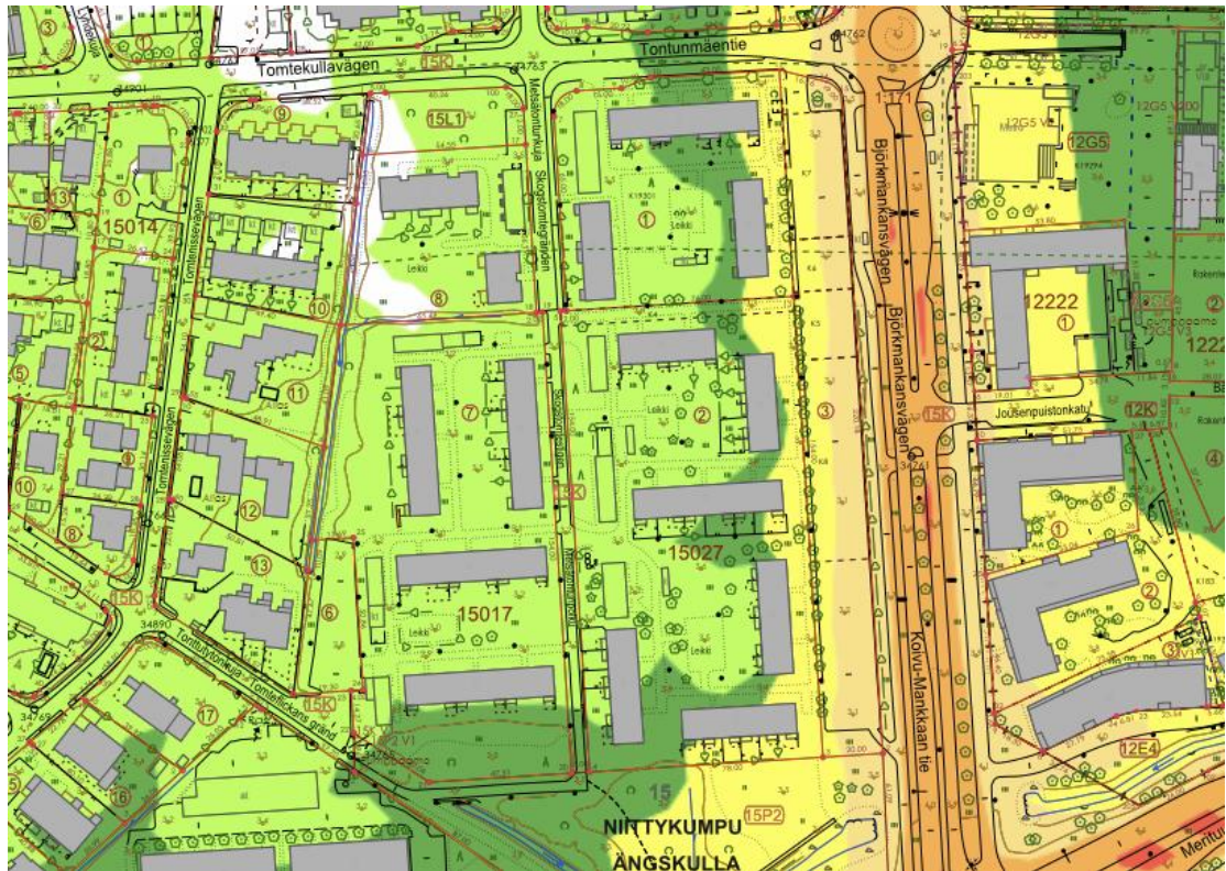
Päiväajan (klo 07–22) meluarvot vuonna 2017. Valkoisella alueella melua on alle 45 dB, vaaleanvihreällä 45–50 dB, tummanvihreällä 50–55 dB, keltaisella 55–60 dB, vaalean oranssilla 60–65 dB ja tummemman oranssilla 65–70 dB.
