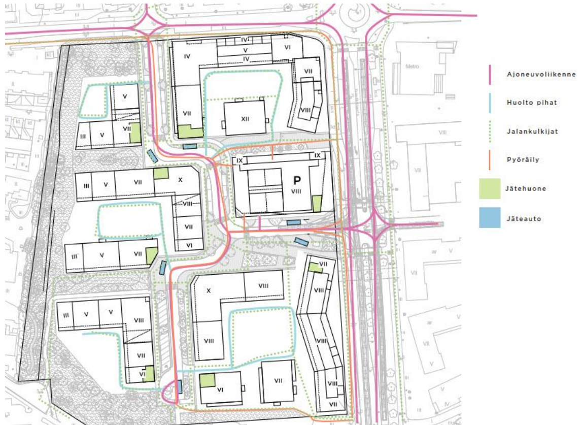
Kuva. Liikennekaavio sekä jätehuoneet ja jäteauton pysähtyminen
