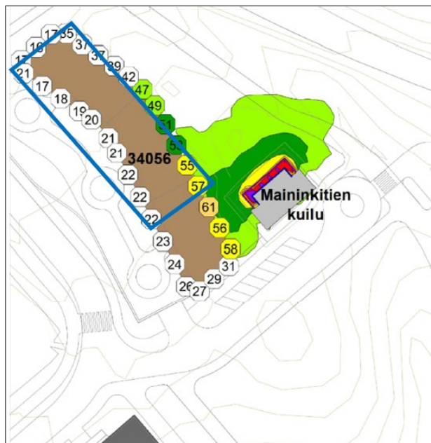
Kuva 20: Metrokuilun savunpoistokuilun koekäyttöpäivän päiväajan A-keskiäänitaso (Akukon 2022). Kuvaa lisätty sinisellä kaavamuutoksessa olevan rakennuksen likimääräinen sijainti
