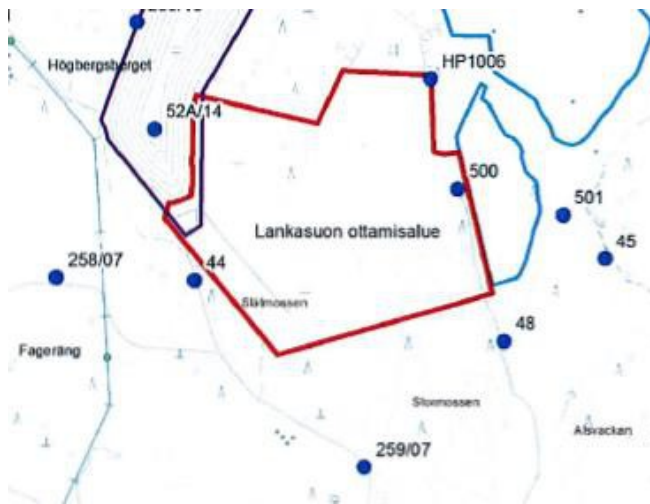
Kartta 15. Pohjaveden havaintoputkia vesien yhteistarkkailuohjelmassa.
