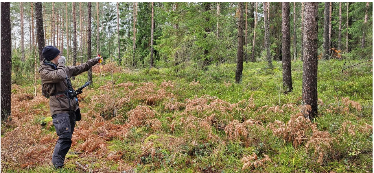
Kuva 5. Kuva maastoinventoinnista relaskoopilla. Kuva: Tiina Peippo.
